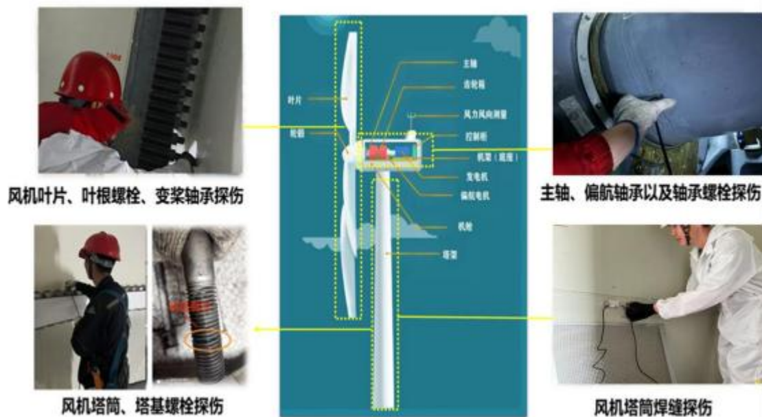
图 2 3D 相控阵超声探伤在风电机组应用场景
