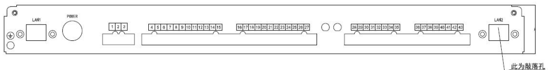
图 4 汇集单元 IED 背板示意图
