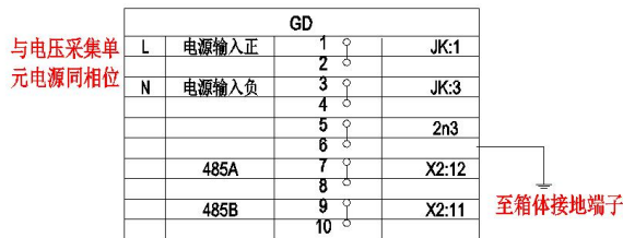
图 2 电流采集单元对外接线图
